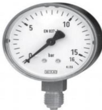
Figura 1.3 Manómetro WIKA, tubo de Bourdon, Modelo 110.10
