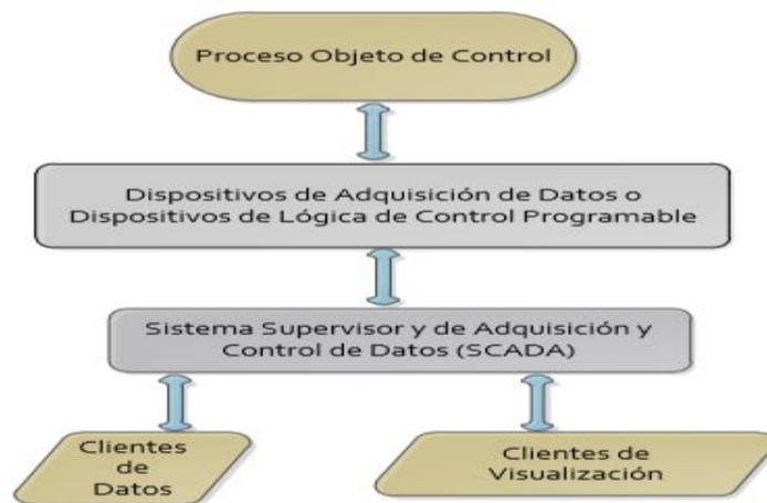
Figura 1.3. Partes de un sistema SCADA
