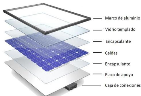
Figura 1. Estructura de un módulo PV. Fuente: [7].
