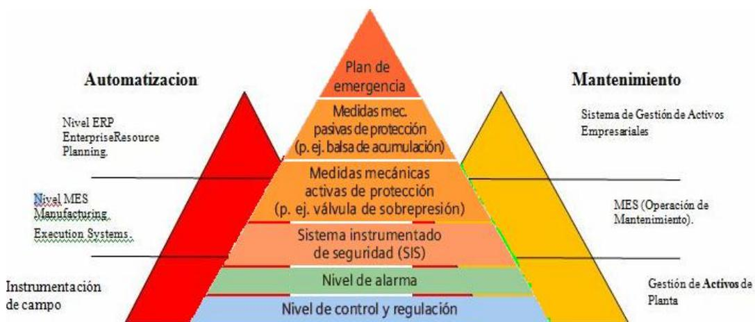
**(Fig. 3). Esquema de nivel de automatización**
