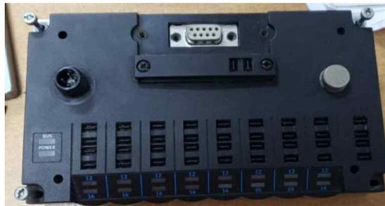
Figura 35. Vista Superior de la Isla Neumática.
