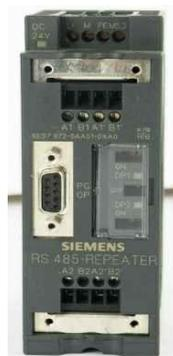
Figura 38. Repetidor RS 485.
