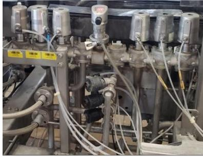
Figura 30. Conexión de las mangueras a las válvulas neumáticas
