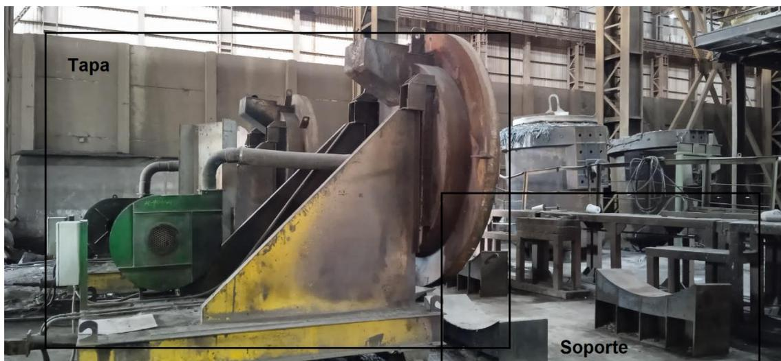
*Figura 26. Estructura externa del Quemador Horizontal.*
