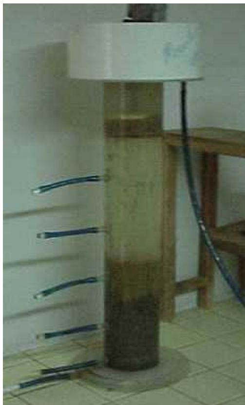
Figura 3. Prototipo de reactor UASB (4.7L), empleado en los ensayos en continuo.
