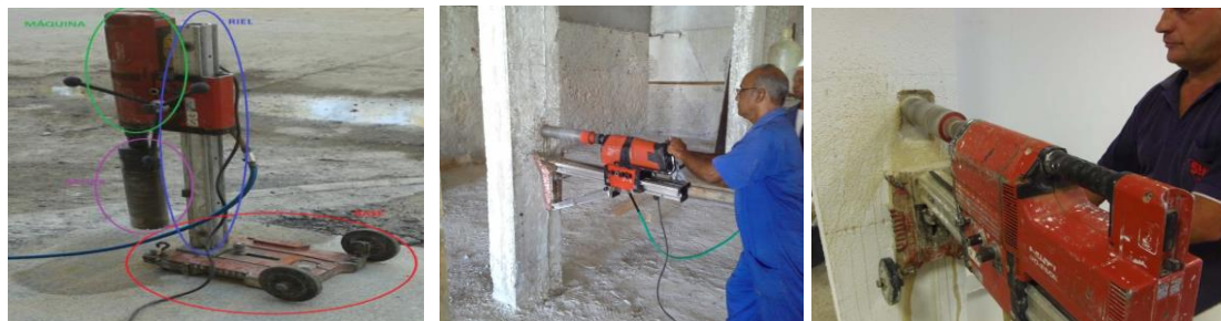
Figura 2.12. Máquina extractora de testigo, ejecución del ensayo y partes componentes del equipo.
