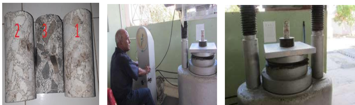
Figura 2.18. Testigos siendo ensayados.
