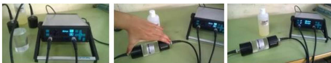
Figura 2.7. Puesta a cero de los transductores exponenciales
