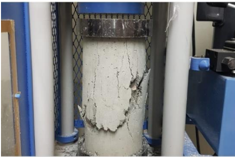
a) Rotura de probeta de hormigón
