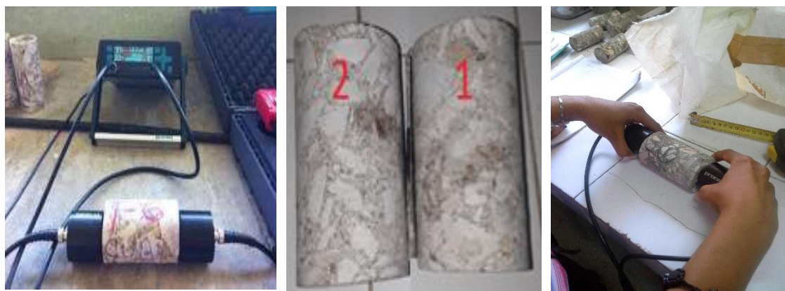
Figura 2.15. ultrasonido del hormigón por método indirecto en piso y por el método directo en los testigos 1 y 2.
