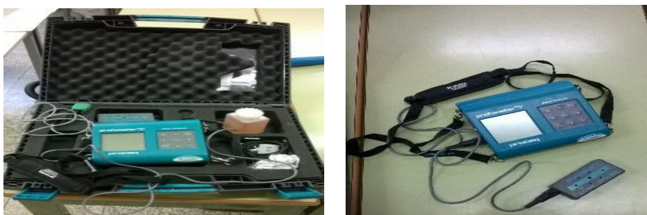
Figura 2.4. Se muestra Detector de Armaduras con sonda universal y cordón de seguridad.
