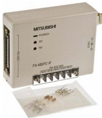
**Módulo de comunicación para MODBUS RTU
