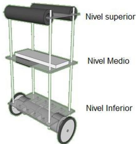
**Figura 2.2:** Estructura General del chasis del robot balancín.
