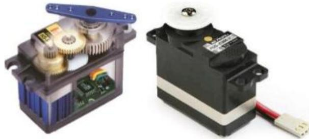
**Figura 1.14:** Servomotores.
