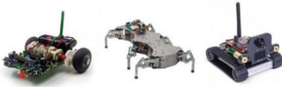
**Figura 1.2:** Robots móviles por ruedas, por patas y por cinta.
