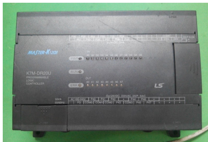
Figura 21. PLC empleado como maqueta MASTER-K120S K7M-DR20U.
