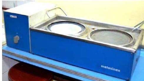
Fig. 2.17 Devastadora pulidora METASINEX.
