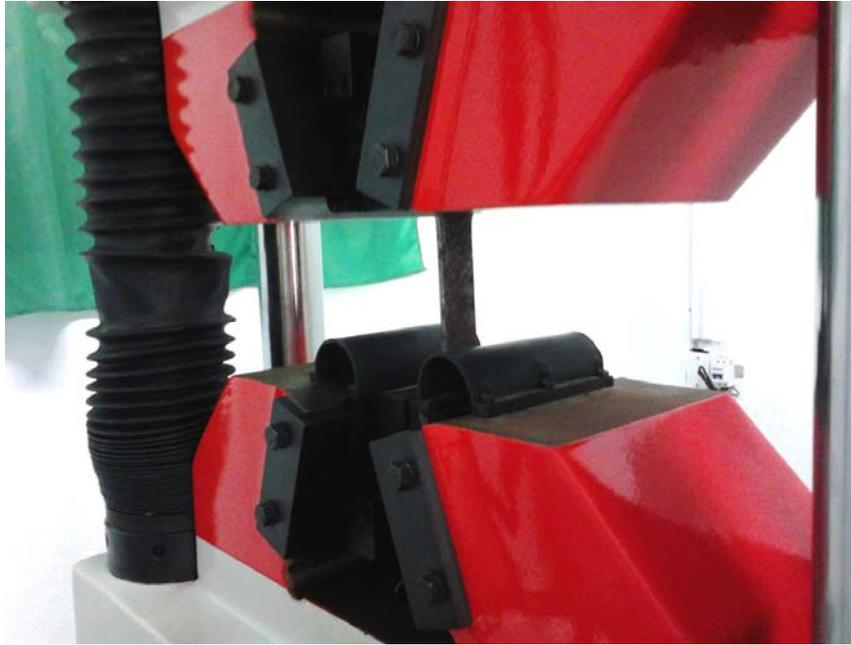
Fig. 2.13 Máquina de ensayos de tracción, modelo YNS 300
