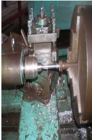
Fig. 2.9 Proceso de torneado de las muestras de tracción.
