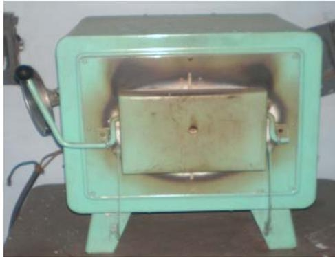
Fig. 2.12 Mufla empleada para el tratamiento térmico de revenido.
