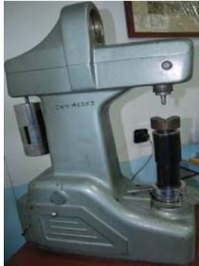
Fig. 2.19 Durómetro Rockwell modelo TK- 2.
