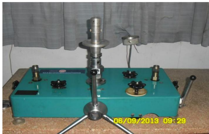
Figura: 1.4 Manómetro de Pistón y Pesas MP - 600
