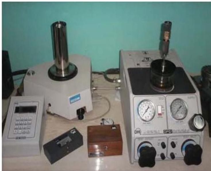
Figura 1.2 se muestra un ejemplo de un Manómetro Patrón de Pistón y Pesas (0,5 MPa a 20 MPa) Clase: 0,02.
