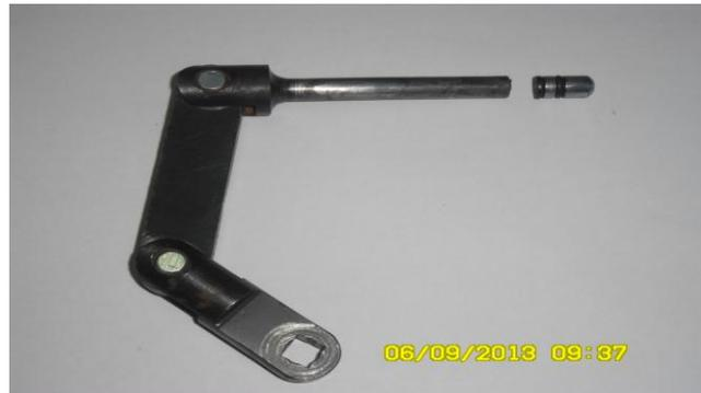
Figura 2.3 Vástago de la Bomba Manual con la rotura.
