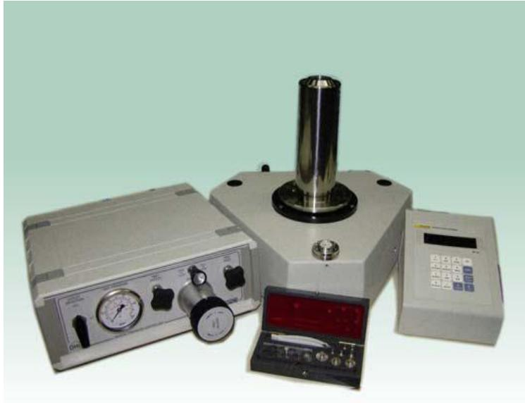
Figura 1.1 se muestra un ejemplo de un Manómetro Patrón de Pistón y Pesas (50 kPa a 2 000 kPa) Clase: 0,02.
