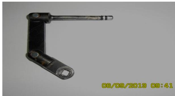
Figura 2.2 Vástago de la Bomba Manual en estado original.
