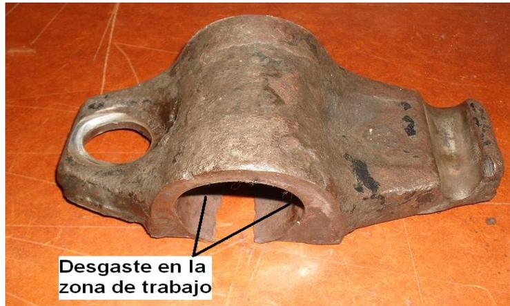
Figura 2. 4: Desgaste en la zona de trabajo del agujero de la orejeta
