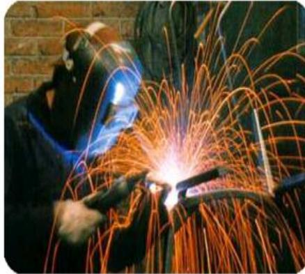
Figura 1.10: Relleno con electrodo revestido
