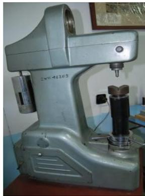
Figura 2.17: Durómetro Rockwell, modelo TK – 2
