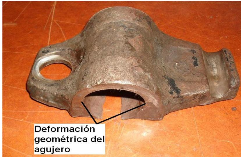
Figura 2. 6: Deformación de la geometría de la orejeta
