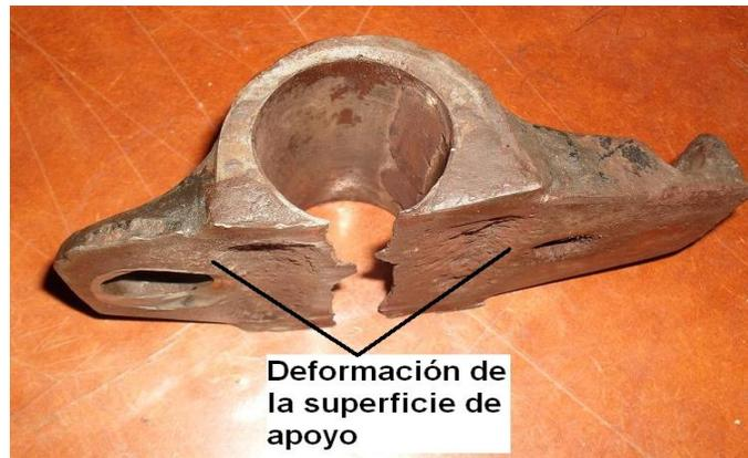
Figura 2. 2: Desalineamiento de la superficie de apoyo de la orejeta
