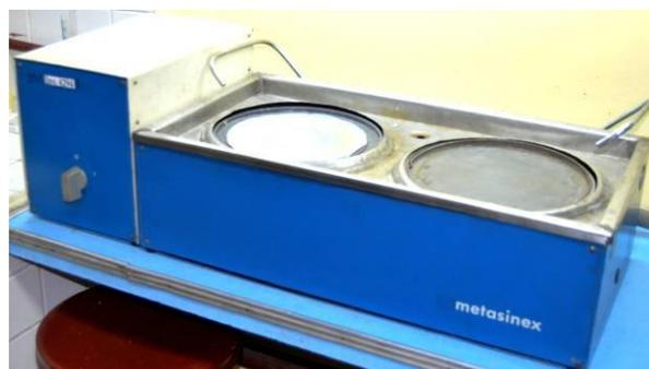
Figura 2. 11: Desbastadora - pulidora METASINEX
