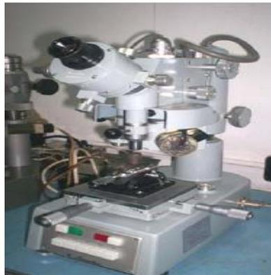
Figura 2. 15: Microdurómetro SHIMADZU M.
