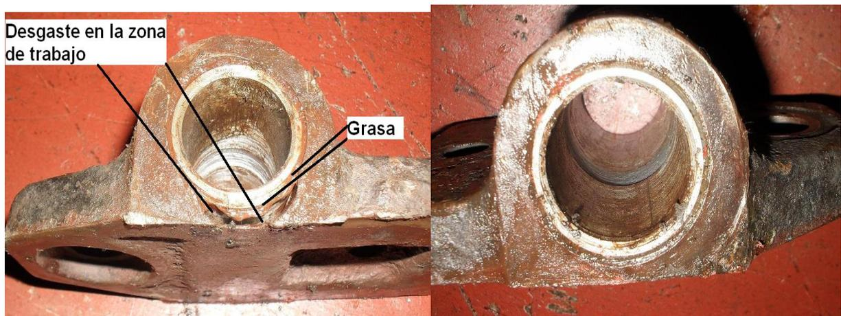
Figura 2. 3: Desgaste en la zona de trabajo del agujero de la orejeta
