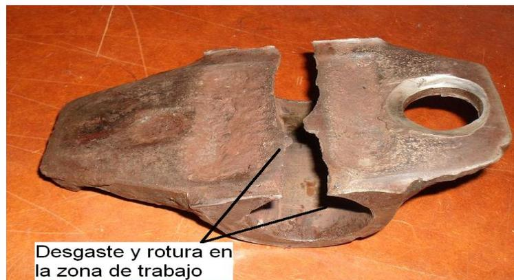
Figura 2. 5: Desgaste y rotura en la zona de trabajo de la superficie de apoyo de la orejeta
