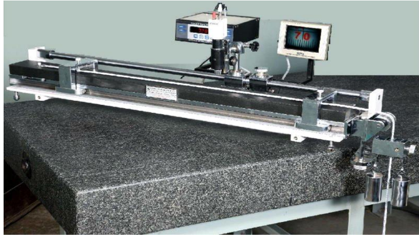
Figura 1.8. Acoplamiento de un sistema de visión de alta exactitud.
