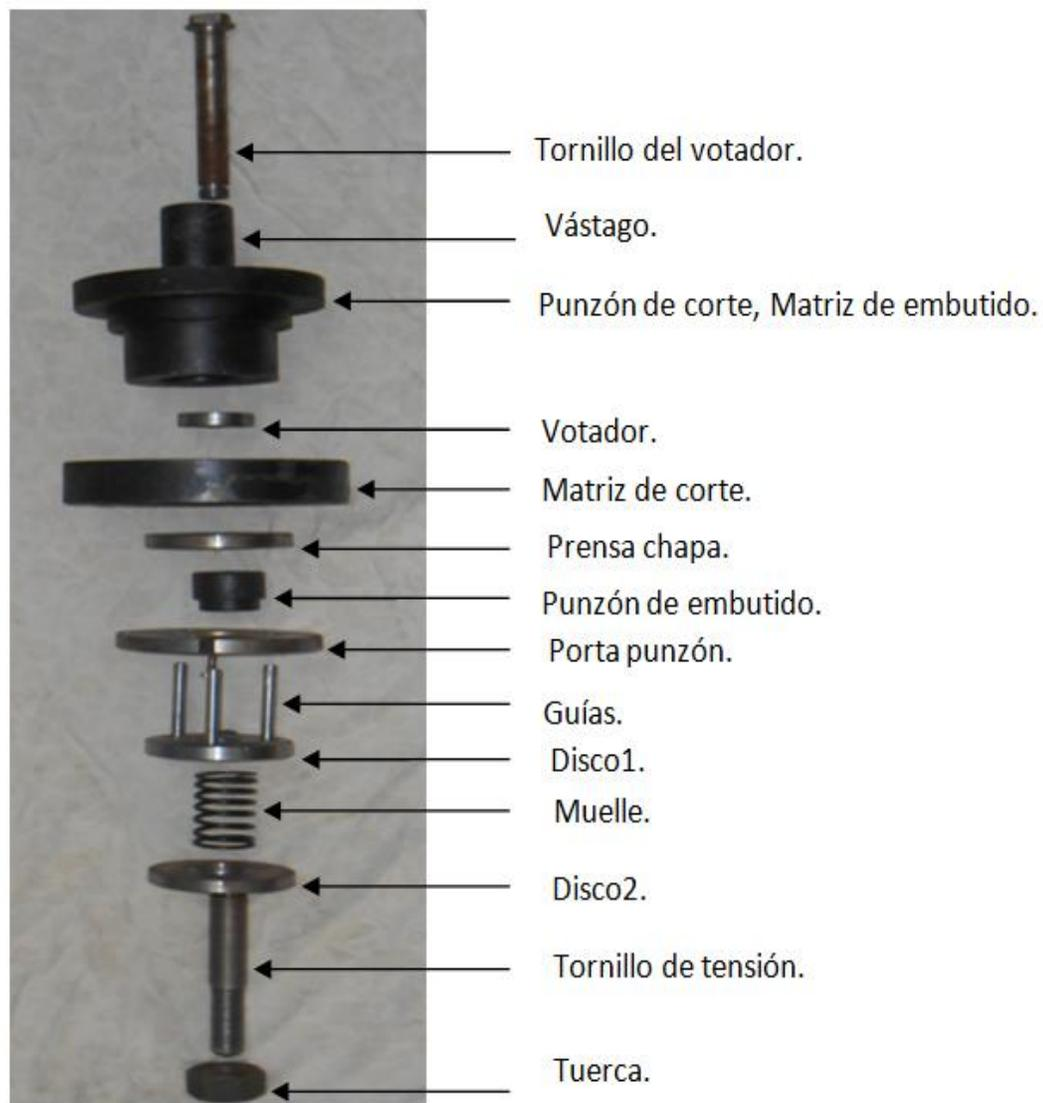
Figura2.4.: Despiece del troquel de corte y embutido.
