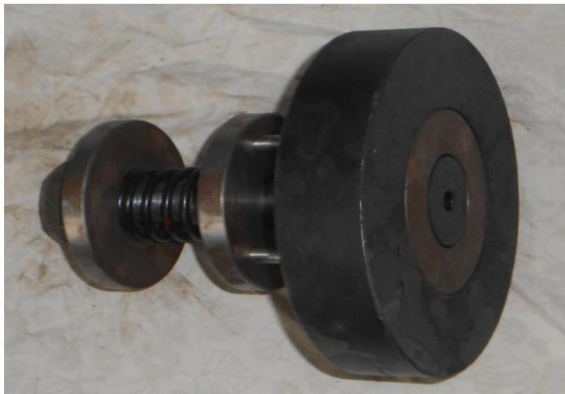
Figura2.6.: Troquel de corte y embutido.
