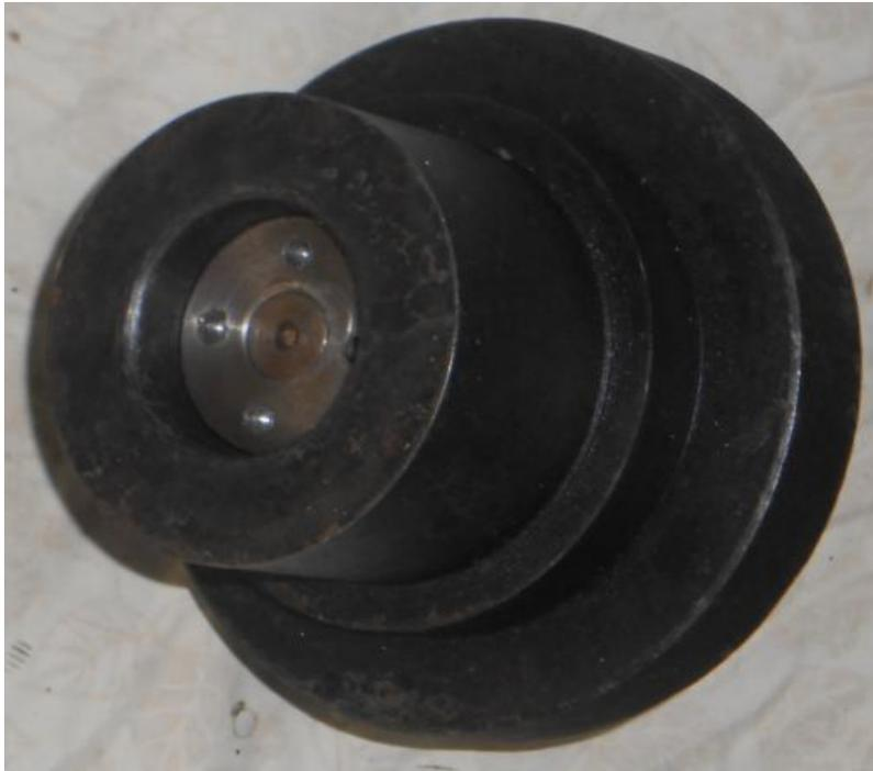
Figura2.5.: Troquel de corte y embutido.
