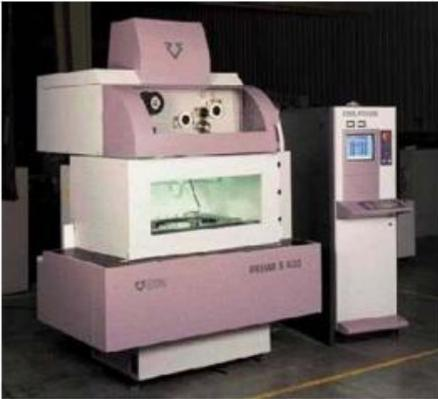
Figura 1.10. Máquina CNC electro erosiva capaz de cortar hasta 600 *mm* de espesor.
