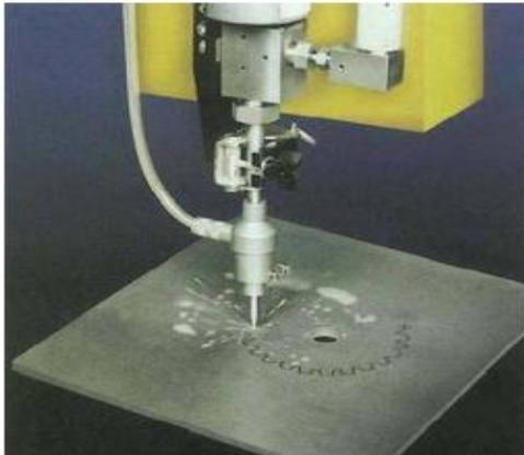
Figura1.11.: Corte por chorro de agua a alta presión.
