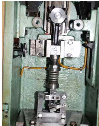
Fig. 2.6 Mecanismo adaptado a la máquina universal de fatiga por impacto.
