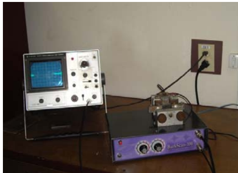
Fig. 2.14 a) Esquema general de medición del RMB.
