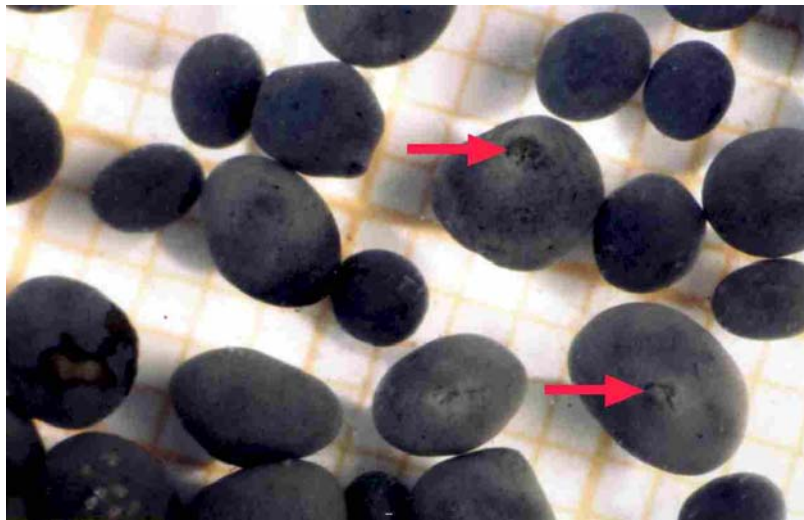
Figura 2. Lodo Granular Anaerobio a partir de un reactor UASB
