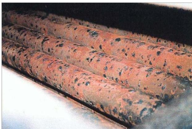
*Figura 1.5 Corrosión por Oxígeno o “Pitting”*
