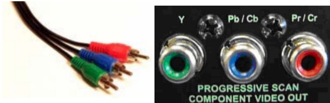
Figura 12 Conectores del video por componentes analógico
