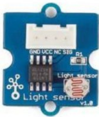
Figura 19 Módulo Sensor de luz CyL (SEN11302).
