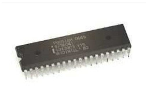
Figura 6 El microcontrolador 8051 de Intel
