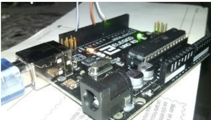
Figura 9 Elegoo UNO R3 es un clon de Arduino, una alternativa a precio reducido.
