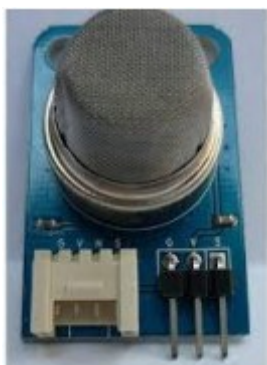
Figura 18 Módulo Sensor de Gas y Humo MQ2 CyL (SEN90512P).
