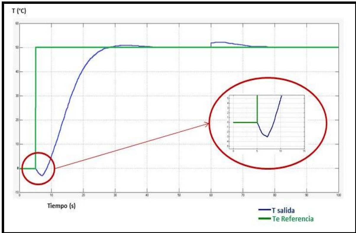
Figura 2.2.3 b: Simulación del sistema con la acción del controlador PI en E-210
