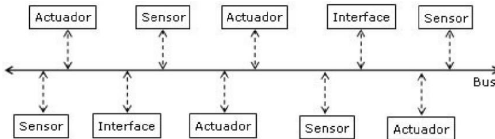
Figura 1.3: Arquitectura domótica distribuida.
