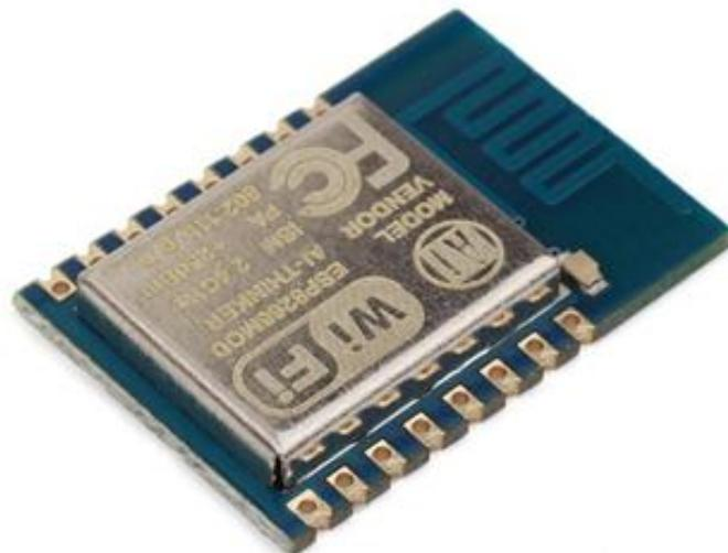
Figura 2.7 Módulo Wi-Fi ESP8266
