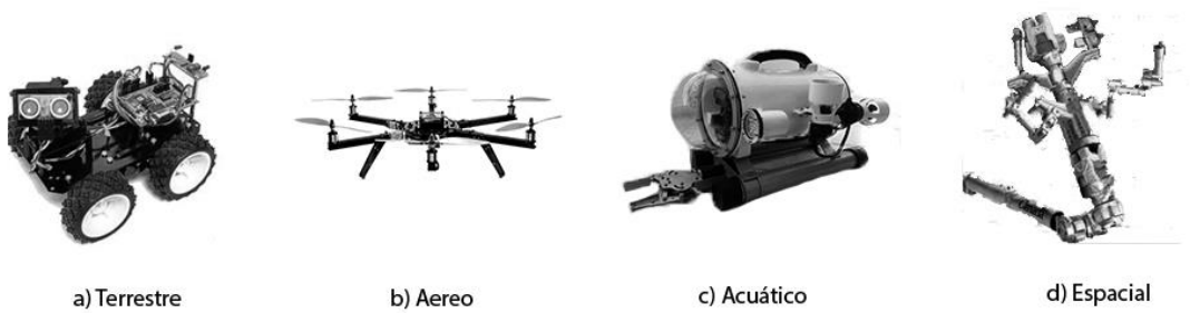
Figura 1.1. Categorías de los robots móviles según forma de locomoción.
