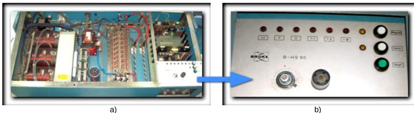
Figura 2.2. Fuente B-HS 90. a) Interior de la fuente. b) Ampliación del panel de operación de la fuente.
