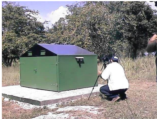
Figura 1.11. Secador solar con ventanillas de regulación del aire.
