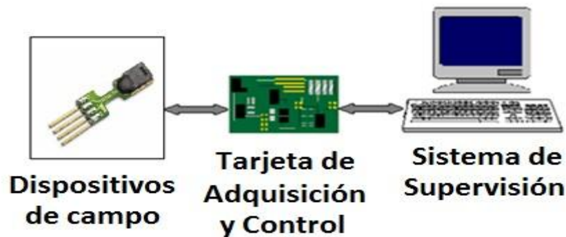
Figura 2.1. Sistema de supervisión y control.
