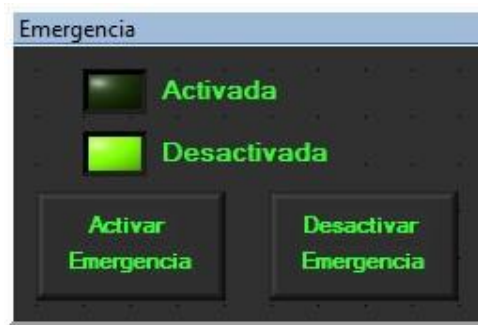
Figura 2.23. Ventana para activar-desactivar parada de emergencia.
