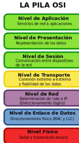
Figura 1.16. Arquitectura del modelo OSI.
