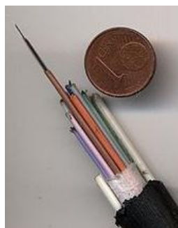
Figura 1.13. Sección de un cable de fibra óptica.
