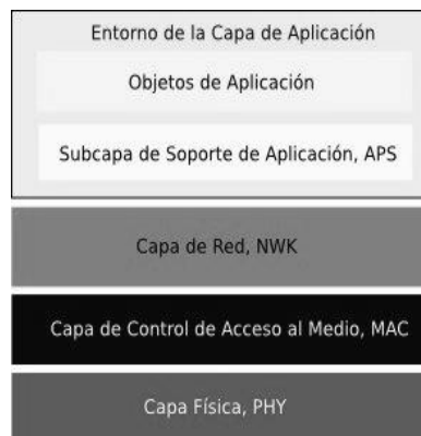
Figura 1.17. Arquitectura en capas del estándar ZigBee/IEEE 802.15.4.
