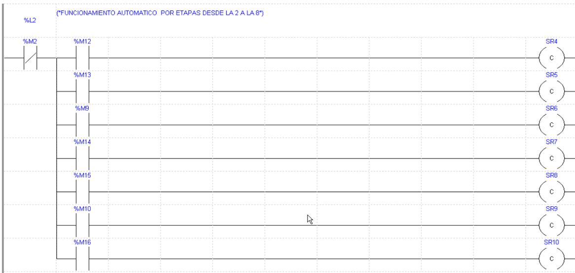
Figura 22. Traducción a LD del segmento de modelado en PN que define la secuencialidad en la ejecución de cada etapa del proceso en funcionamiento automático.
