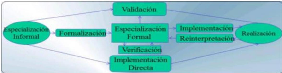
Fig. 1.1 Ciclo de diseño de la Automatización Industrial <sup>[13]</sup>.
