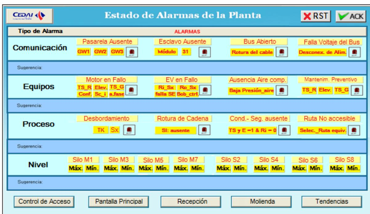
Fig. 2.15: Pantalla de Alarmas del Sistema Supervisorio.
