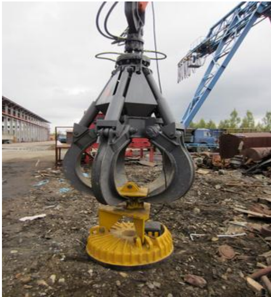
Pulpo manipulador de chatarra. Filtro magnético.
