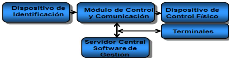
Figura 1.10. Esquema de un Sistema de Control de Acceso Centralizado.
