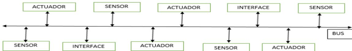
Figura 1.3. Esquema de arquitectura de un sistema inmótico distribuido.
