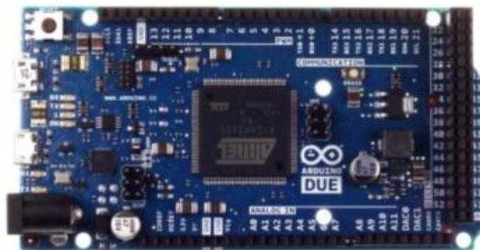
Figura 2.5. Placa electrónica Arduino DUE.
