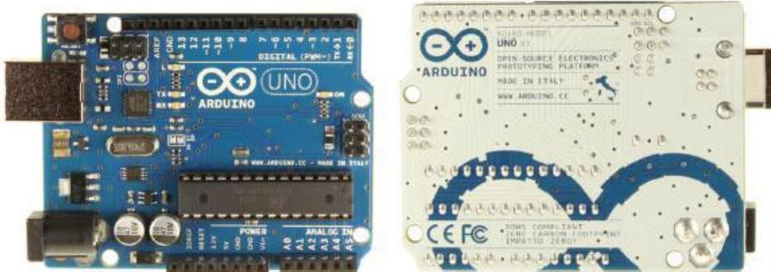
**Figura 1. 1:** Frontal y reverso de la placa Arduino Uno.
