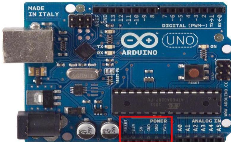
**Figura 1. 2:** Pines de alimentación (Power Pins).
