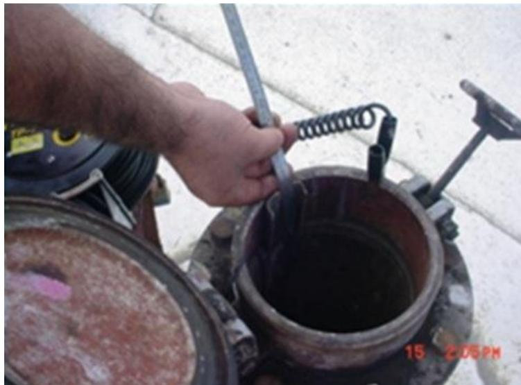
*Figura 2. Punto de referencia de los tanques*
