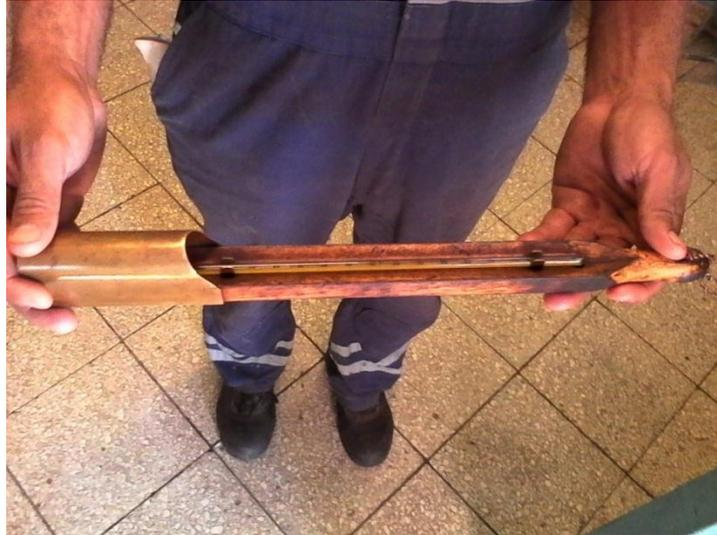
*Figura 3. Termómetro para medir temperatura en los tanques*
