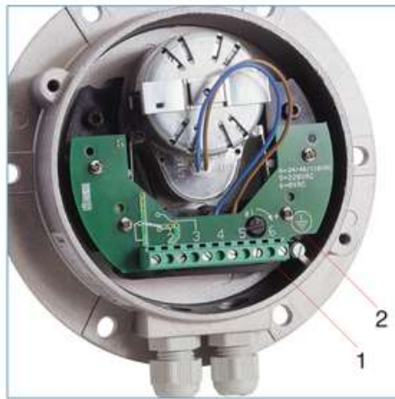
1. Bornes de conexión. 2. Tornillo de regulación.
