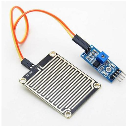
**Figura 2.8:** Sensor de lluvia MH-RD.
