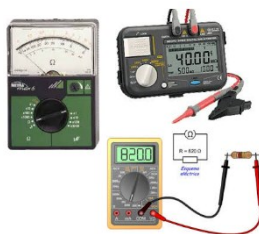
Figura 1.4: Formas de medición directa de resistencia.
