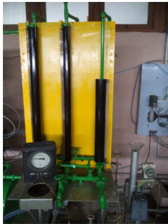
Figura 2.5: Instalación de la práctica de medición de nivel o presión.
