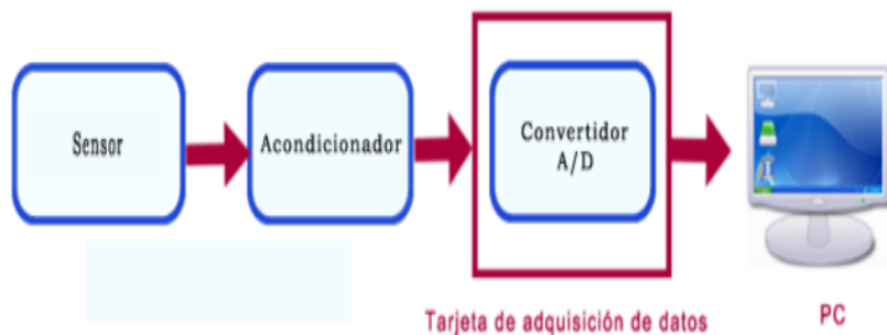
Figura 1.17: Esquema del sistema de adquisición de datos.
