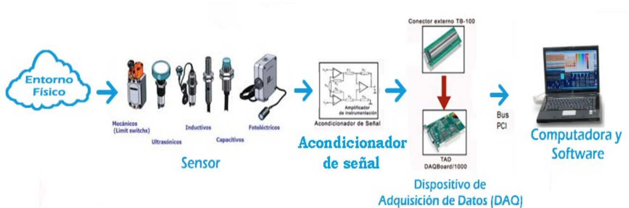
Figura 2.1: Sistema propuesto para la medición de magnitudes físicas.
