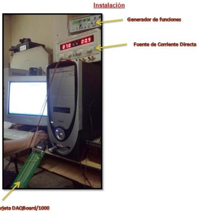
Se realizó la medición trabajando con una señal de CD de 7V por un tiempo de 83 mseg, con una frecuencia de muestreo de 100 escaneos por milisegundo (100 kHz). Inicio inmediato, stop por número de escaneos.
