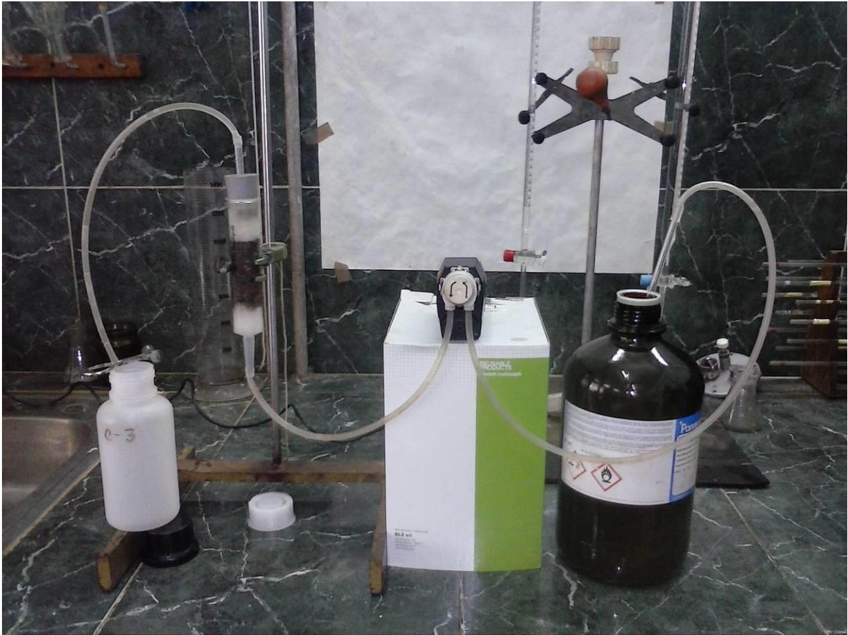
Imagen B.4. Instalación para la corrida del experimento de bioadsorción en columna (Concentración inicial de Ni:  $76,28 \text{ mg}\cdot\text{L}^{-1}$ ; pH: 8,5; Flujo:  $2,5 \text{ mL}/\text{min}$ ; Temperatura:  $35^\circ\text{C}$ ; biomasa:  $7,01 \text{ g}$ ; Volumen del Lecho:  $30 \text{ mL}$ ).
